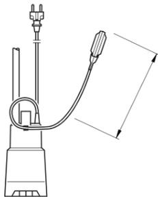
El punto de paro y arranque de la bomba puede reajustarse alargando el interruptor de flotador en su dispositivo de graduación.
