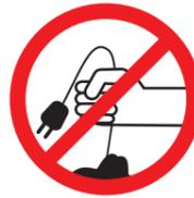
**Deberá sujetar la bomba por la agarradera prevista. Nunca debe instalar su bomba de manera que cuelgue libremente de la tubería a presión o del cable de corriente.**
